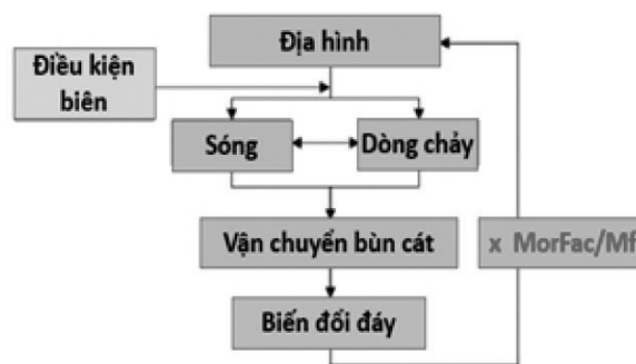
Hình 2. Sơ đồ hệ số MorFac trong Delft3D
