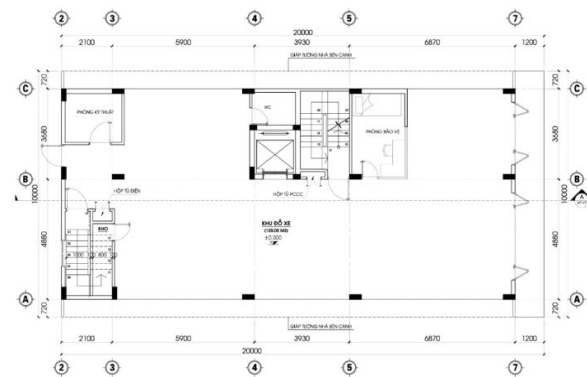
Hình 5: Mặt bằng tầng 1 chung cư mini với hai đường luồng hai bên kích thước 720 mm
