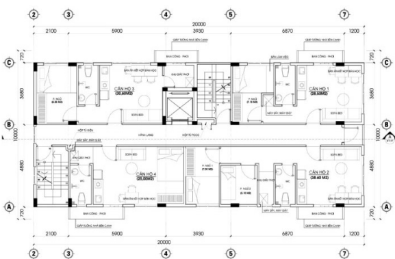
Hình 4: Mặt bằng điển hình phương án 2 gồm 4 căn hộ với quy mô căn hộ đa dạng
