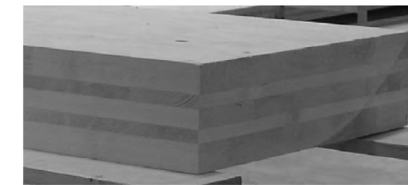
Hình 2: Cấu trúc lớp chéo và mẫu tấm CLT sau chế tạo [4]
