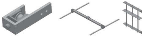
Cụm căng đai Cụm trục xy Cụm trục z Hình 4. Các cụm thiết kế chính của máy khắc laser CO_2
