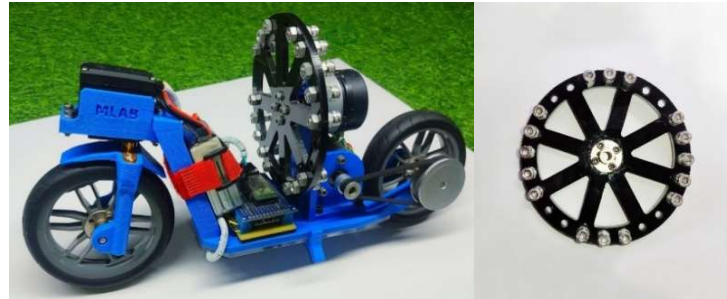
Hình 11. Mô hình xe và cụm bánh đà sau khi lắp ráp hoàn chỉnh
