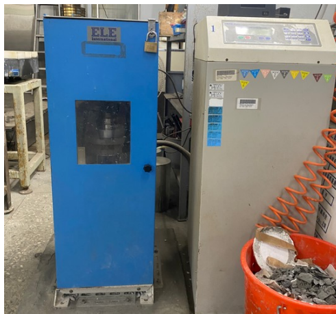
Hình 4. Hình ảnh thí nghiệm đo cường độ chịu nén trong 28 ngày và 56 ngày
