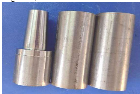
Hình 3.5. Hình ảnh phôi thép SUS304 trước và sau khi gia công bề mặt cần kiểm tra độ nhám
