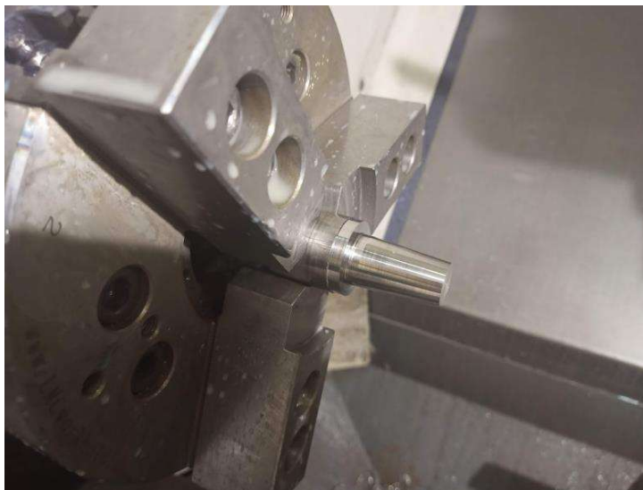
Hình 3.6. Gá đặt và tiến hành gia công bề mặt theo chế độ cắt cho từng mẫu thí nghiệm
