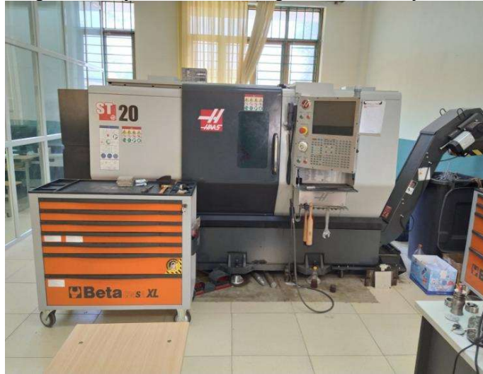
Hình 3.1. Máy tiện CNC mã hiệu HAAS – ST20
