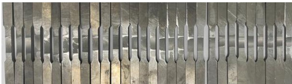
Hình 5. Một số mẫu thử kéo đã gia công theo tiêu chuẩn
