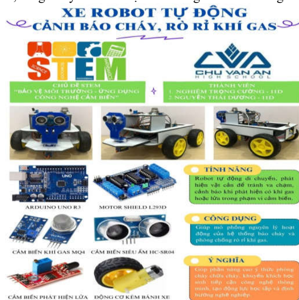
Hình 1. Xe robot tự động cảnh báo cháy, rò rỉ khí gas
