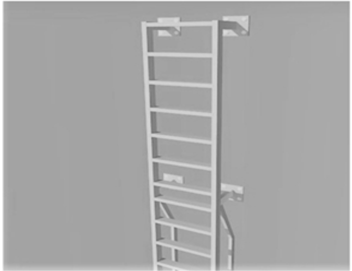
Chi tiết bản mã của đỉnh thang được liên kết vào đá bằng bulong. Bản mã có kích thước 25 x 25cm đến 30 x 30cm tùy thuộc vào điều kiện thực tế
