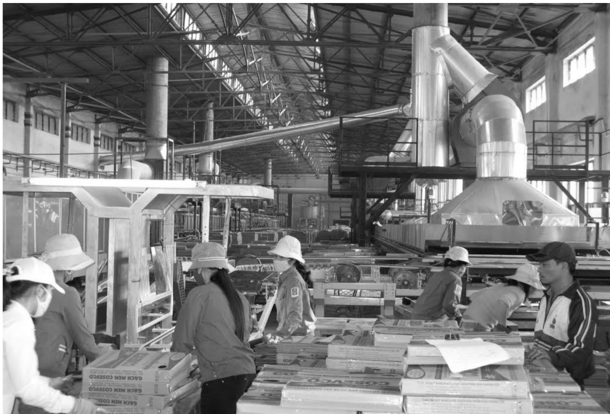
Dây chuyền sản xuất ngói tráng men cao cấp công nghệ ép bán khô, xương bán sứ của Công ty CP Gốm sứ và Xây dựng Cosevco Quảng Bình
