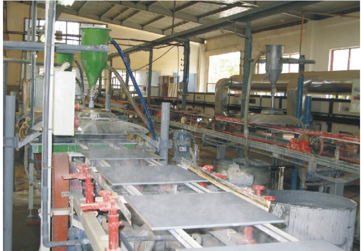
Đề tài “Sản xuất thử nghiệm ngói tráng men cao cấp công nghệ ép bán khô, xương bán sứ”
