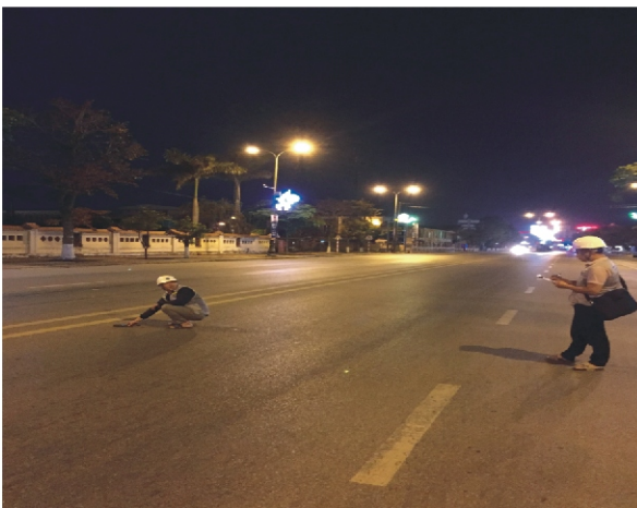
Đo hệ thống chiếu sáng công cộng
