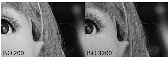
Hình 2. Một bức ảnh được chụp với mức ISO quá cao sẽ bị nhiễu
