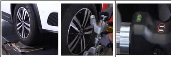
Bước 6-7: Truy cập vào cơ sở dữ liệu xe, chọn nhà sản xuất, model và phiên bản xe. Khóa vô lăng bằng dụng cụ chuyên dụng để tránh dịch chuyển khi đẩy/kéo xe.
