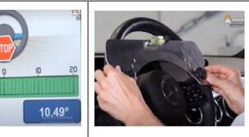
Bước 22-23: Các góc đặt bánh xe không đạt tiêu chuẩn sẽ được tô màu đỏ. Nâng xe lên để chuẩn bị điều chỉnh.
