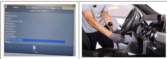
Bước 8-9: Thực hiện bù đảo (compensation) bằng cách kéo, đẩy xe tới lui theo hướng dẫn trên màn hình đến khi hoàn tất. Tháo chốt khóa và cao su trên đĩa xoay.
