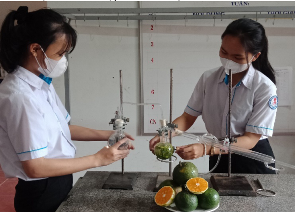
Hình 2.1. Học sinh nghiên cứu tách tinh dầu từ vỏ cam bằng thiết bị Clevenger trong phòng thí nghiệm
