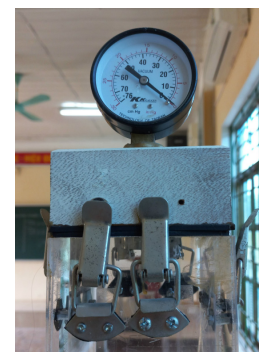
Hình 2.3: Áp kế và nắp buồng chân không
