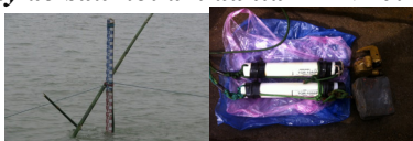
Hình 2.3. Lắp đặt trạm nghiệm triều
