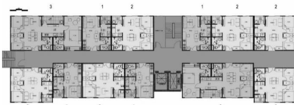
Hình 4. Mặt bằng tầng điển hình chung cư NOXH dạng tấm tổ hợp bởi các căn hộ mẫu
