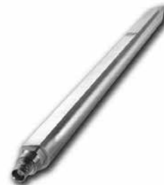
Hình 2. Đầu đo áp lực sóng xung kích mã hiệu PCB Piezotronics 137B21B - Máy đo động đa năng NI SCXI-1000DC
