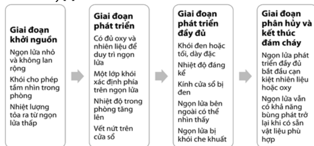
Hình 1. Đặc điểm các giai đoạn của đám cháy trong công trình dân dụng
