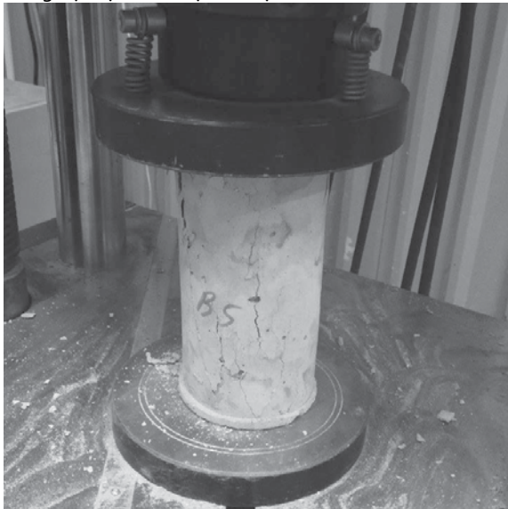
Hình 1. Mẫu bị phá hoại sau khi nén
