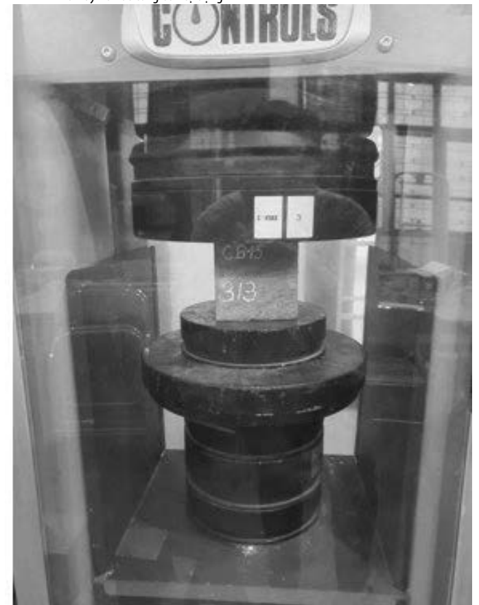
Hình 5. Nén thí nghiệm kiểm tra cường độ bê tông
