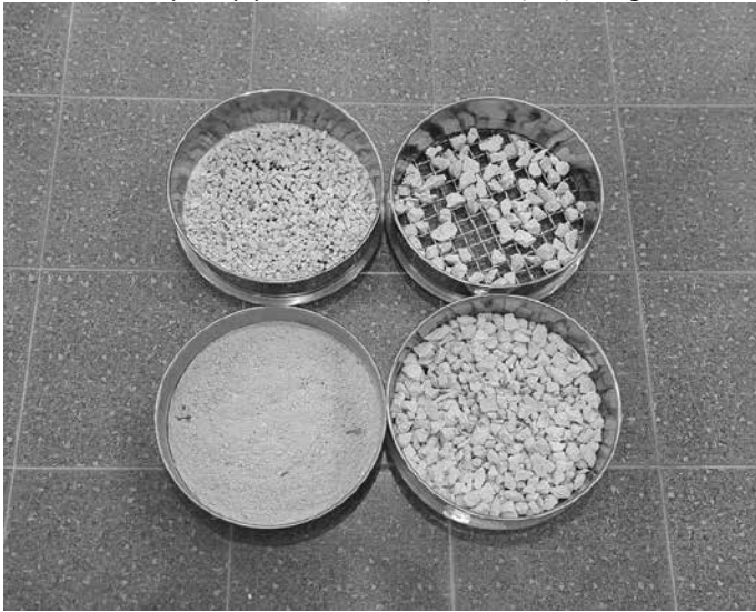
Hình 2. San hô làm cốt liệu bê tông
