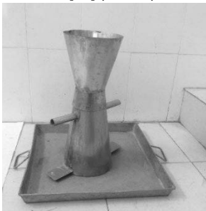
Hình 4. Xác định độ sụt của hỗn hợp bê tông
