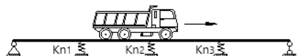
Hình 5. Sơ đồ phân tích dao động cầu Suối Tượng có xét hệ liên kết ngang
