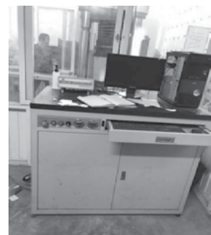
Hình 3.2. Hệ thống điều chỉnh tải trọng và tốc độ nén (theo chuyển vị và lực)
