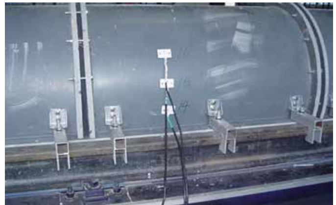
Hình 2. Lắp đặt các vị trí đầu đo ứng suất vỏ hầm trên mô hình thu nhỏ.
