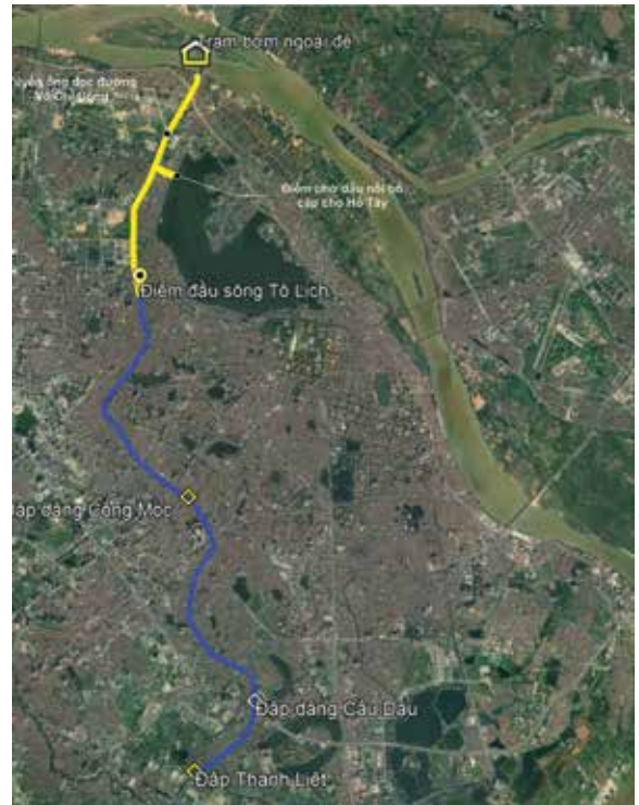
Hình 2. Phương án hướng tuyến dẫn nước sông Hồng để bổ cập và vị trí các đập dâng theo đề xuất của Sở Xây dựng Hà Nội [Nguồn: 8]
