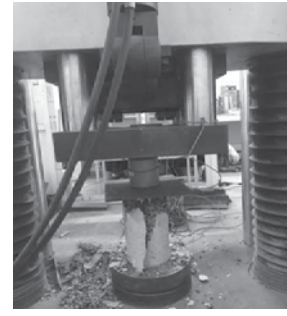
Hình 3.5. Gia tải đến khi mẫu thí nghiệm bị phá hoại
