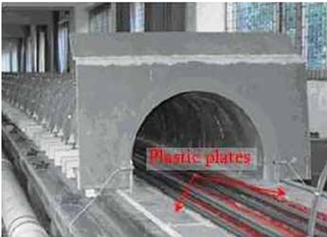
Hình 3. Mô hình vật lý cho đường sắt tốc độ cao và hầm cho tàu chạy.
