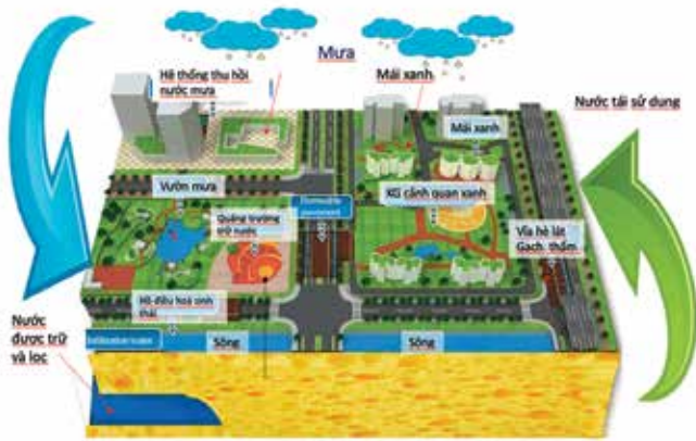
Hình 1. Sơ đồ mô phỏng nguyên tắc và các giải pháp ứng dụng trong thành phố Bọt biển để tối đa hoá khả năng hấp thụ, thấm thấu nước và tái sử dụng nước cho hoạt động đô thị.
