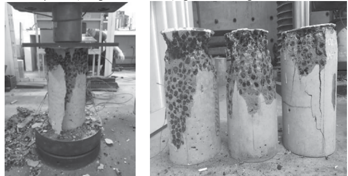
Hình 3.6. Thí nghiệm đến khi mẫu bị nén vỡ phá hoại
