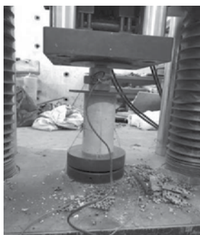
Hình 3.3. Sử dụng máy nén thủy lực SANS 3000
