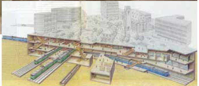
Hình 4. Phối cảnh đường hầm tàu điện ngầm men theo đường nằm nông ở Đức.
