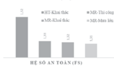
Hình 9. Biểu đồ kết quả đánh giá hệ số an toàn tổng thể
