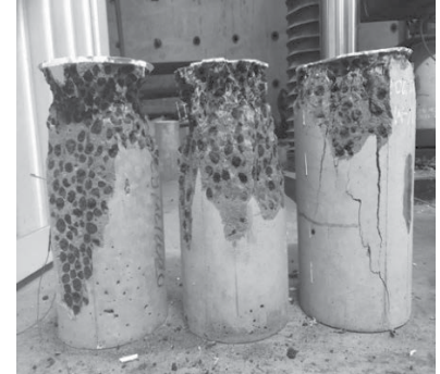
Hình 3.6. Thí nghiệm đến khi mẫu bị nén vỡ phá hoại
