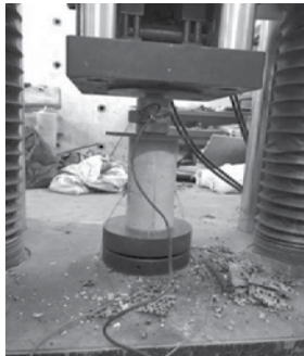
Hình 3.3. Sử dụng máy nén thủy lực SANS 3000
