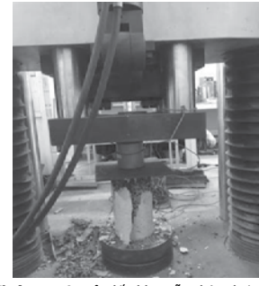
Hình 3.5. Giá tải đến khi mẫu thí nghiệm bị phá hoại
