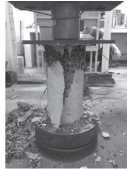
Hình 3.6. Thí nghiệm đến khi mẫu bị nén vỡ phá hoại
