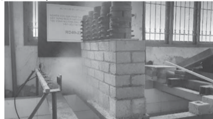
Hình 11. Thử nghiệm độ bền chịu nước của khối xây (ở trạng thái đang chịu tải)
