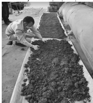
Hình 3. Chuẩn bị mẫu đất để tiến hành thí nghiệm trong Phòng thí nghiệm [3]
