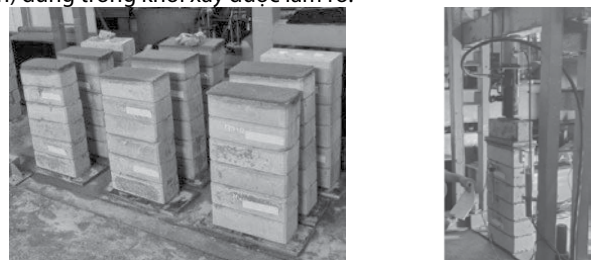
Hình 12. Thí nghiệm khả năng chịu nén của khối xây [7]
