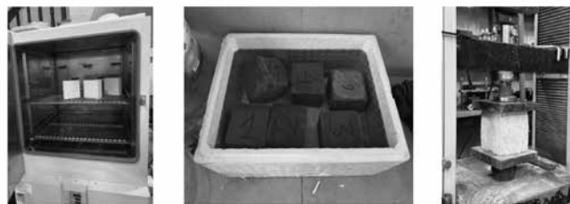
Sấy mẫu trước ở 40°C đến khô, ngâm nước trong ít nhất 72 giờ để khối lượng ổn định, Nén mẫu bê tông
