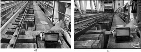
Hình 2. Thực nghiệm đo đặc dao động cầu và ray tại Cầu Thăng Long
