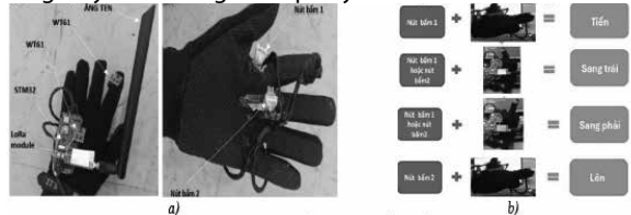
Hình 4. Hình ảnh (a) găng tay cảm biến và (b) lệnh điều khiển cho Quadcopter
