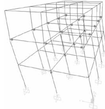
Hình 7. Biến dạng của công trình ở trạng thái phá hủy DS5
