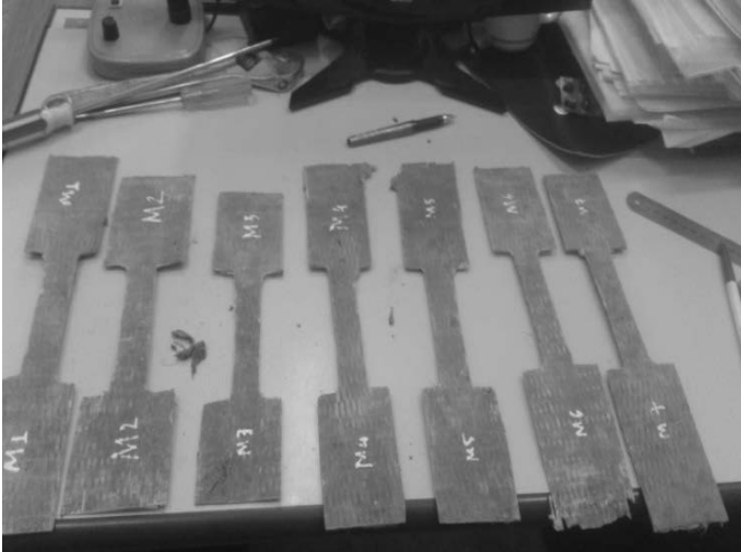
Hình 11. Mẫu thí nghiệm vật liệu Sợi FRP
