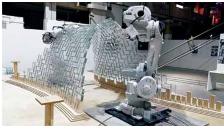
Hình 10. Sử dụng 2 robot công nghiệp cung cấp bởi U.K.-based Global Robots để xây dựng một khung vòm ngoạn mục từ 338 viên gạch kính trong suốt từ Poesia Glass Studio (nguồn: [7])
