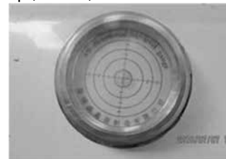
Hình 12: Máy được kiểm tra cân bằng ngang, bọt thủy phải ở bên trong vòng tròn nhỏ nhất của đồng hồ cân bằng
