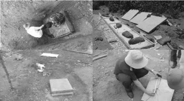
Hình 3. Thí nghiệm đo giá trị chuyển vị, biến dạng đối với tấm BTCT
