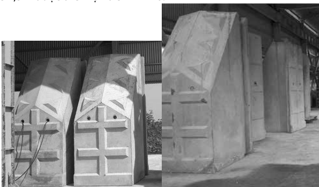
Hình 6. Hình dạng cấu kiện kè 3,5m
