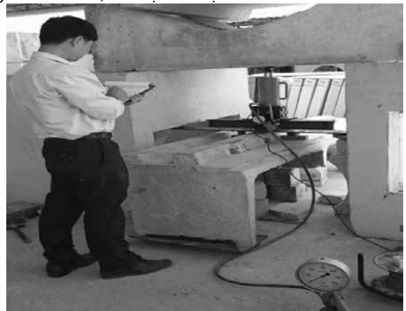
Hình 8. Thử tải tấm chống xói và tấm ghép cơ đê B=2m
