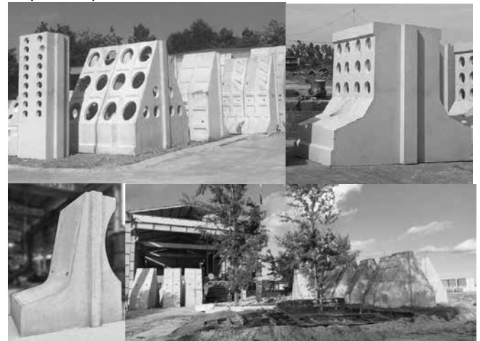
Hình 12. Hình ảnh thực tế một số cấu kiện bê tông cốt sợi đúc sẵn
