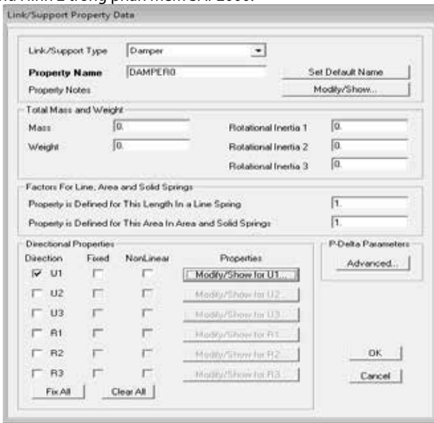
Hình 2. Các đặc tính phần tử "line spring"
