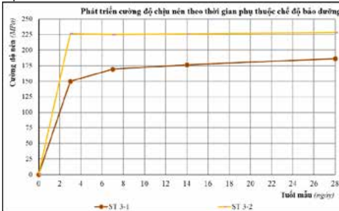
Hình 3. Ảnh hưởng của chế độ bảo dưỡng đến phát triển cường độ nén theo thời gian.
