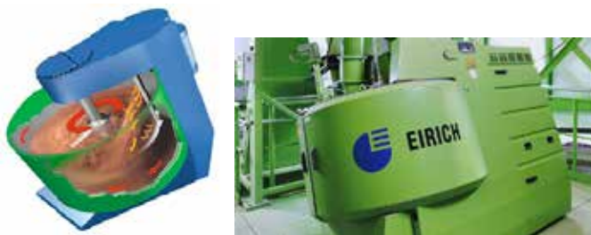
Hình 8. Máy trộn trục nghiêng tăng cường EIRICH- Đức
