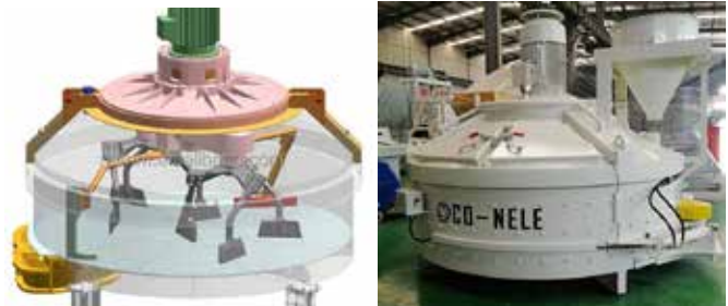
Hình 9. Máy trộn hành tinh trục đứng tăng cường CO-NELE-Trung Quốc
