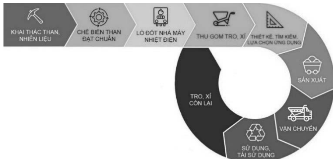
Hình 5. Mô hình tuần hoàn sử dụng tro, xỉ làm vật liệu xây dựng
