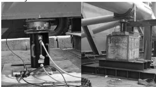
Hình 16. Kích thủy lực gắn Loadcell
