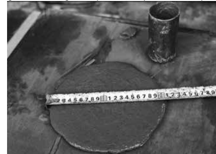
Hình 6. Thử nghiệm độ chảy xòe
