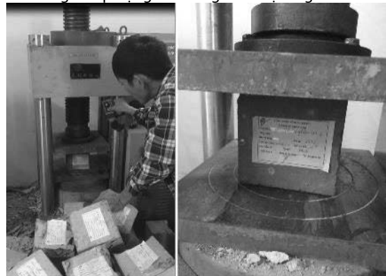
Hình 8. Thí nghiệm nén mẫu tiêu chuẩn 150x150x150mm
