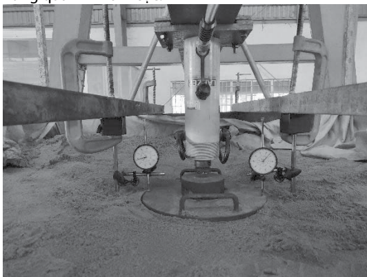
Hình 8. Thí nghiệm xác định mô đun của đất nền
