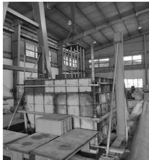
Hình 5. Mô hình cọc đưa vào thùng chứa đất
