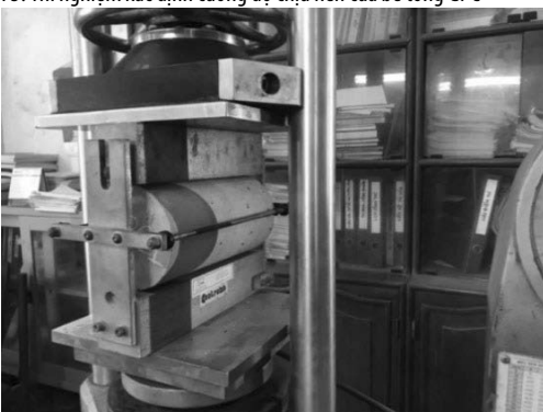
Hình 6. Thí nghiệm ép chẻ bê tông GPC
