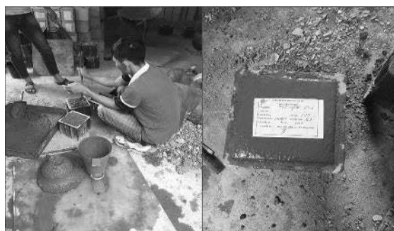
Hình 7. Chế tạo mẫu thí nghiệm
