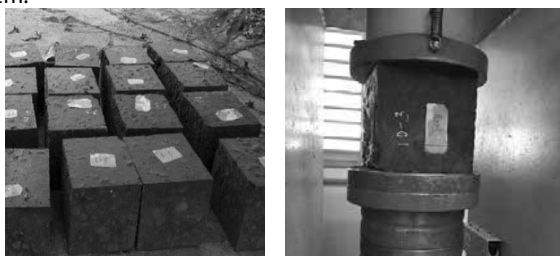
Hình 4. Thí nghiệm xác định cường độ nén
