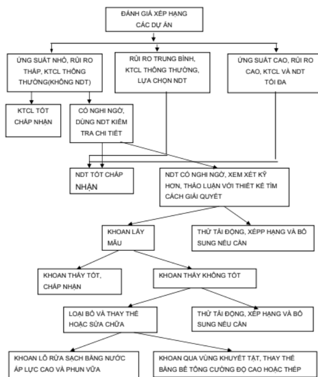
Hình 1. Sơ đồ dùng để đánh giá và xử lý cọc khoan nhồi [7]
