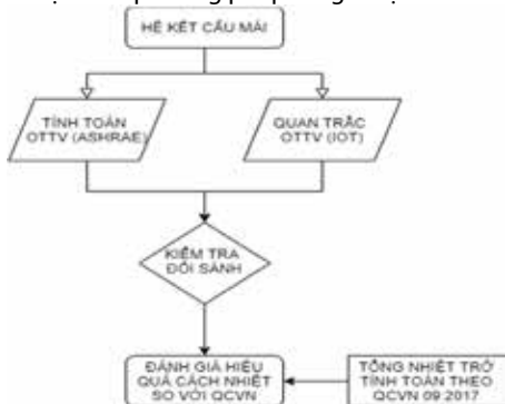
Hình 1. Phương pháp đánh giá hiệu quả cách nhiệt của kết cấu mái công trình được nghiên cứu thực hiện
