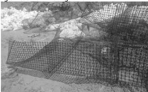
Hình 3. Vỏ lưới nhựa được chế tạo từ nhựa HDPE
