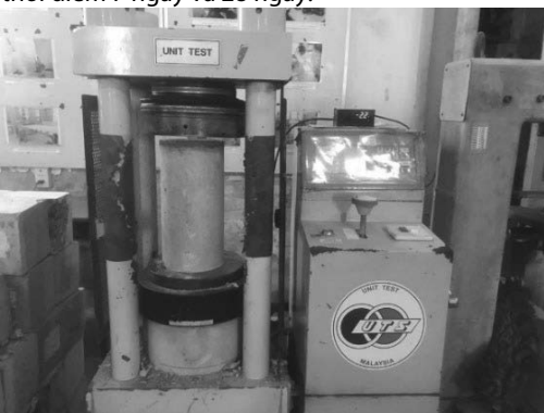
Hình 5. Thí nghiệm xác định cường độ chịu nén của bê tông GPC
