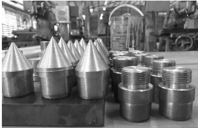
Hình 4. Mô hình gia công cọc thí nghiệm
