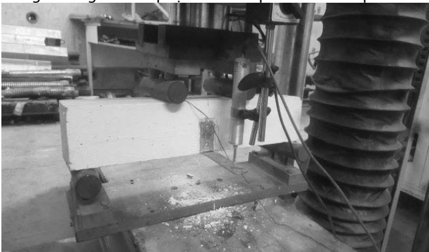
Hình 6. Hình ảnh uốn dầm xác định P_{max}
