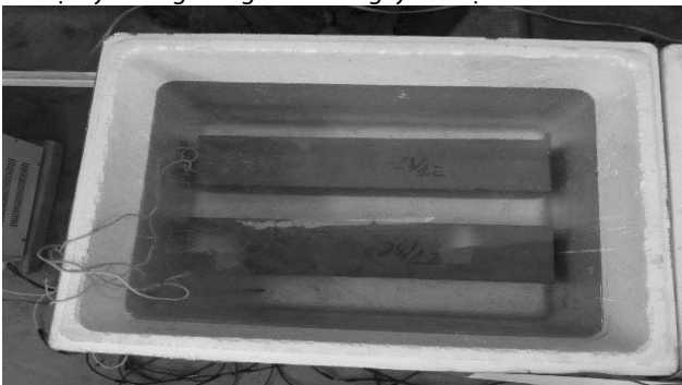
Hình 7. Hình ảnh ngâm dầm không gia tải
