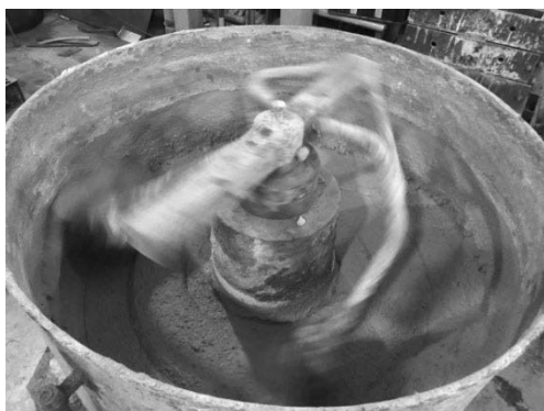
Hình 3. Trộn hỗn hợp bê tông GPC
