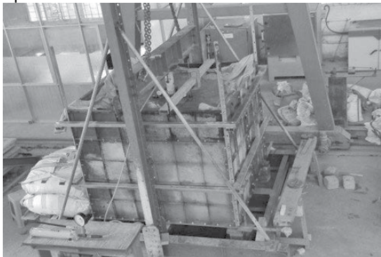
Hình 7. Mô hình thùng chứa đất thí nghiệm nén hệ móng bè - cọc
