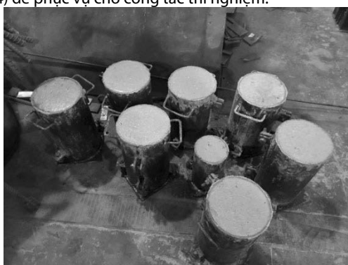
Hình 4. Khuôn mẫu sau khi đổ bê tông GPC
