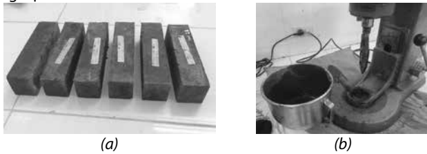
Hình 5 - (a) Các mẫu thí nghiệm và (b) máy trộn hỗn hợp bê tông hạt mịn
