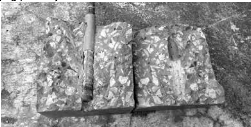
Hình 9. Sự phá hoại mẫu GRAC với thép 20 mm
