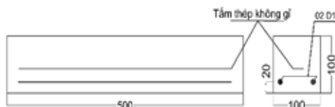
Hình 3. Kích thước và cấu tạo dầm thực nghiệm
