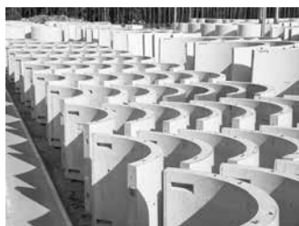
Hình 3.19. Phân đoạn ngắn công nghệ Max Bogl, các mặt tiếp xúc được mài bằng máy CNC - [50]
