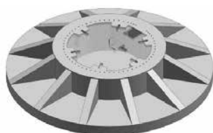
Hình 3.18. Phân đoạn dài công nghệ Acciona, móng BTCT với các bệ neo cấp dự ứng lực - [53]
