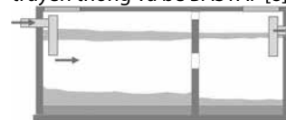
Hình 5. Bể tự hoại truyền thống
