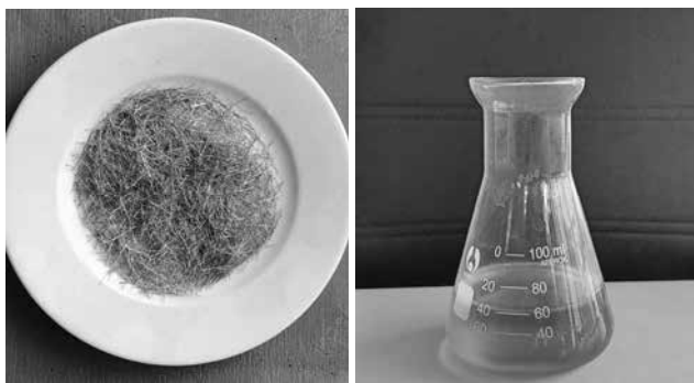
Hình 3 - Cốt sợi thép phân tán và phụ gia dẻo gốc PCE dùng trong nghiên cứu b) Các thiết bị sử dụng:
