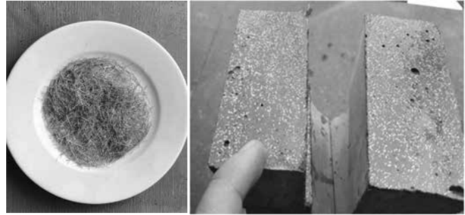
Hình 5. Cốt sợi thép và sự phân tán sợi thép trong UHPC
