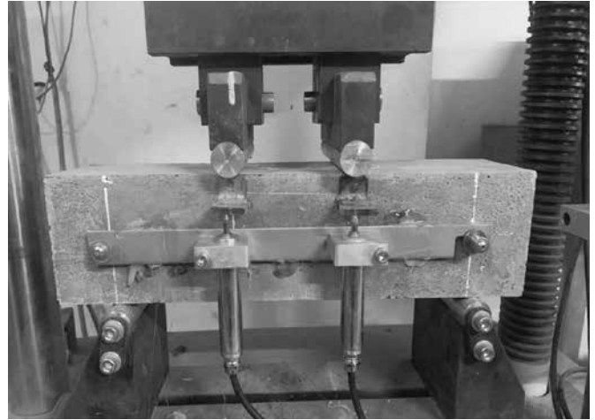
Hình 11. Thí nghiệm xác định đường cong ứng suất – độ võng chịu kéo khi uốn mẫu UHPC
