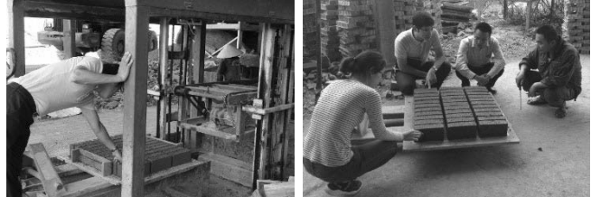
Hình 7. Sản xuất thử nghiệm GBT sử dụng XMG trên dây chuyền sản xuất thực tế tại nhà máy
