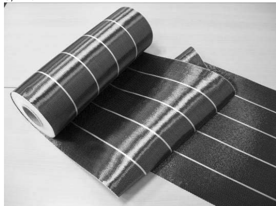
Hình 2. Tấm CFRP UT70-30G
