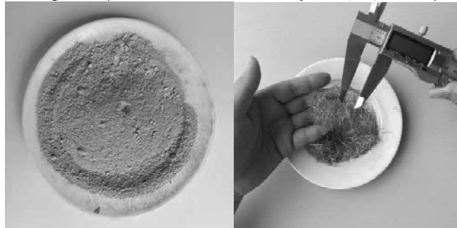
Hình 3. Silica fume và Sợi thép sử dụng trong nghiên cứu này
