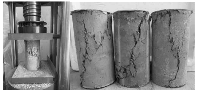
Hình 9. Mẫu nén và kiểm tra cường độ chịu nén của các mẫu UHPC-SF
