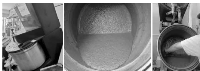
Hình 4. Thiết bị trộn tăng cường UHPC tốc độ cao tại phòng thí nghiệm
