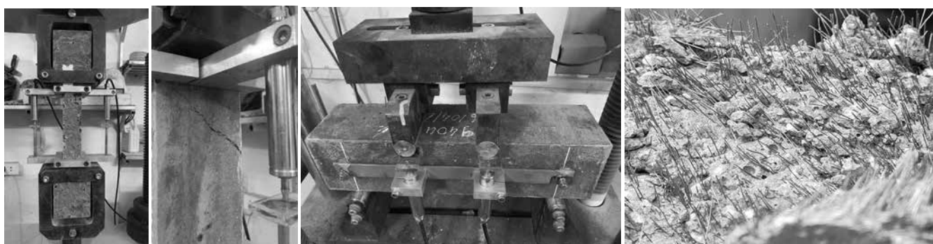
Hình 15. Kiểm tra ứng suất – biến dạng kéo và uốn của các mẫu UHPC-SF
