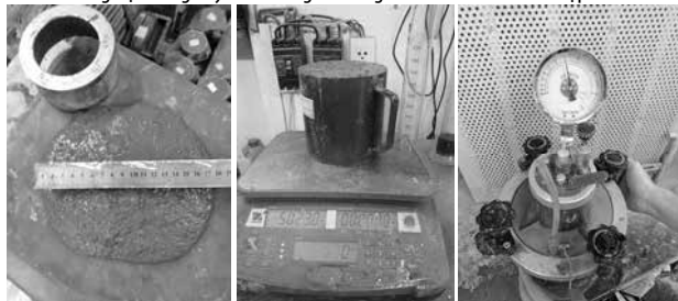
Hình 8. Các thử nghiệm liên quan đến tính công tác của các mẫu hỗn hợp UHPC-SF
