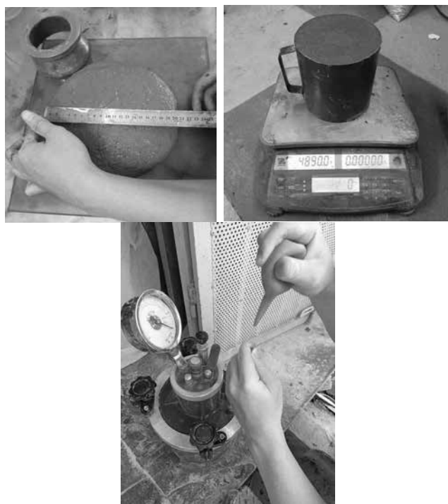
Hình 4. Các thử nghiệm liên quan đến tính công tác của các mẫu hỗn hợp UHPC/RHA-SF
