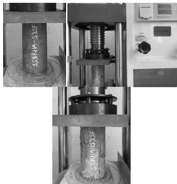
Hình 5. Mẫu nén và kiểm tra cường độ chịu nén của các mẫu UHPC/RHA-SF
