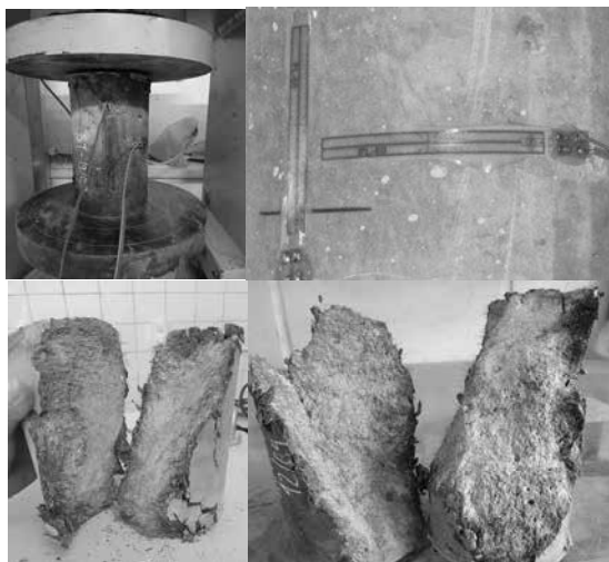
Hình 11. Xác định Modul đàn hồi và hệ số Poisson's của các mẫu UHPC-SF
