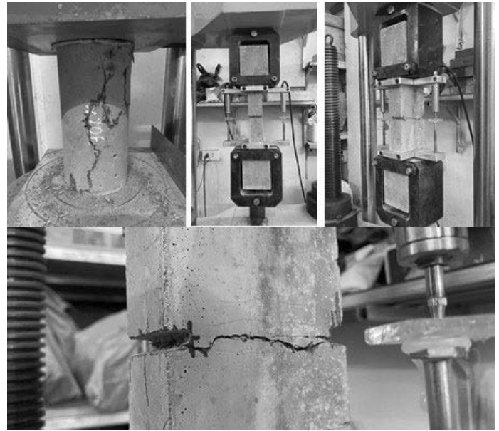
Hình 11. Thí nghiệm cường độ chịu nén, cường độ chịu kéo các mẫu UHPC - Hybrid
