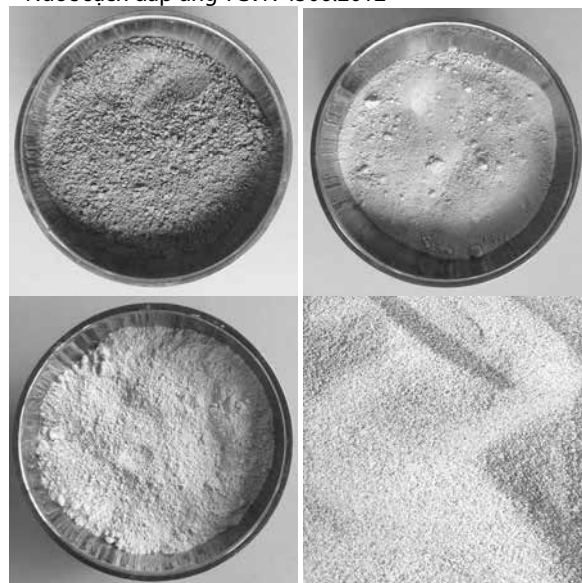
Hình 4. Xi măng, Silica fume, GGBS và cát thạch anh sử dụng trong nghiên cứu này
