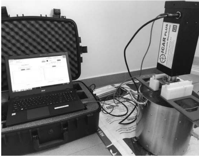
Hình 2. Lưu biến kế ICAR Plus được sử dụng để đo các thông số lưu biến của hỗn hợp bê tông
