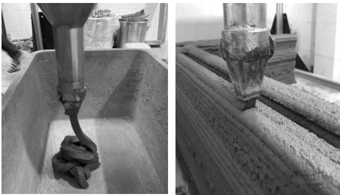
Hình 6. Thử nghiệm khả năng in 3D của các hỗn hợp bê tông
