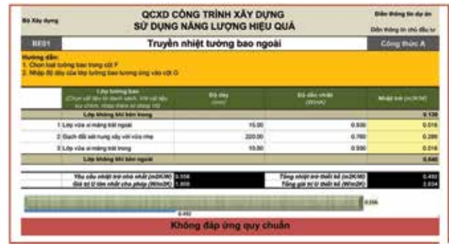
Hình 3. Ví dụ đánh giá hiệu quả cách nhiệt của lớp tường gạch truyền thống
