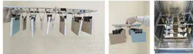
Hình 9. Thử nghiệm khả năng kháng nấm mốc của tấm thạch cao tại VIBM
