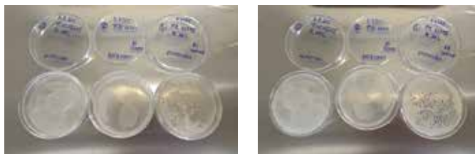
Hình 10. Thử nghiệm khả năng kháng khuẩn của sơn kháng khuẩn tại Viện Vật liệu xây dựng
