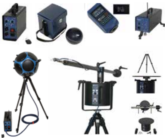
Hình 6. Hệ thống thiết bị đo cách âm của Viện Vật liệu xây dựng
