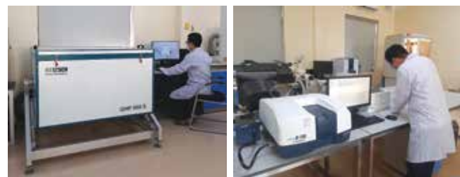
Hình 4. Thiết bị thử nghiệm tính năng nhiệt của vật liệu xây dựng
