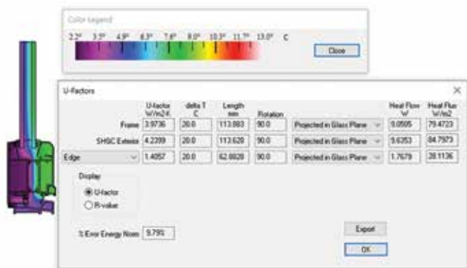
Hình 1. Đặc trưng nhiệt của khung cửa được tính và mô phỏng bởi phần mềm THERM
