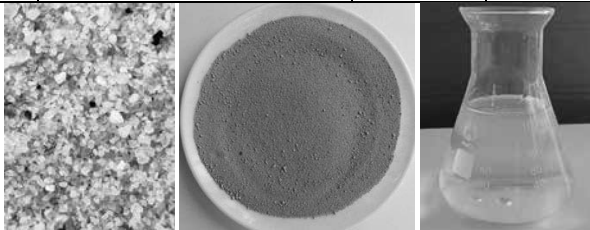
Hình 5. Cát thạch anh, Silica fume, phụ gia dẻo sử dụng để chế tạo UHPC
