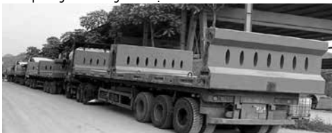
Hình 17. Vận chuyển các phân đốt dầm thuận lợi, đặc biệt là đường tại vùng núi cao
